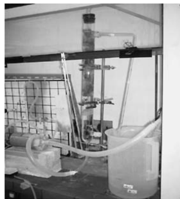
写真2 薬液処理により硫化水素吸着剤を再生
