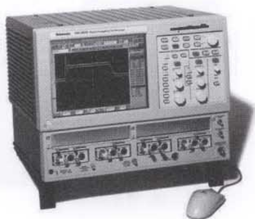
型式：80E04（テクトロニクス） 周波数：20GHz, クロック立上り時間:35ps
