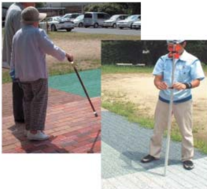
歩行性評価(写真左)とクッション性能測定(写真右)の様子
