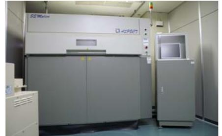
用途：高精度微細造形を可能とする粉末焼結積層方式を利用して、多様な樹脂材料による強度に優れた三次元形状部品などを作成することができる造形装置です。
