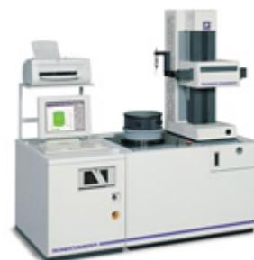
用途：本装置は、電気マイクロメータと空気軸受を用いて、半径法により測定物の内外径の真円度・同心度等を測定するとともに、高精度真直送り機能により各種の円筒形状（円筒度・真直度等）を測定する、テーブル回転型の真円度・円筒形状測定機です。また、自動心出し機構と、自動傾斜・自動水平修正機構とを備えていますので、高速で傾斜修正、水平心出しを行うことができます。
