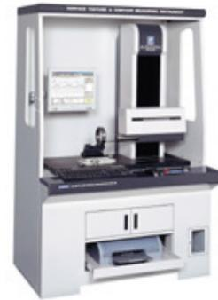
用途：本装置は、検出器に高安定化倍光路型 He-Ne レーザ干渉計、駆動部にリニアモータを搭載し、高分解能で各種表面粗さを測定するとともに、CNC テーブルを利用することで3次元的な表面性状の評価をする、高精度の表面粗さ・輪郭形状測定機です。また、今までの装置では対応していなかった最新の ISO、JIS、DIN、ASME など国際規格や各国新旧規格に対応した測定を行うことができます。
