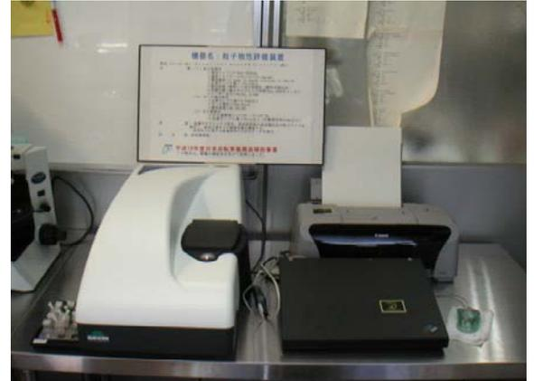
用途： 金属やセラミックス粉末、界面活性剤の表面電位及び粒子サイズを測定し、粉末の液中での凝集状態を調査する。
