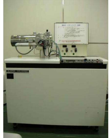
用途： 金属、セラミックス、半導体、樹脂などの表面汚染の除去
