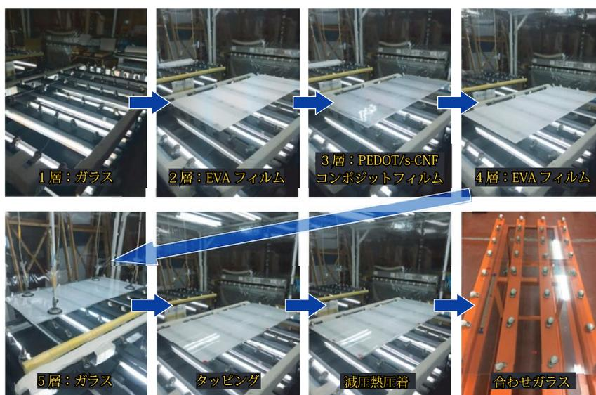
図7 PEDOT/s-CNF-PVA フィルムを遮熱中間膜とした合わせガラスの作製
