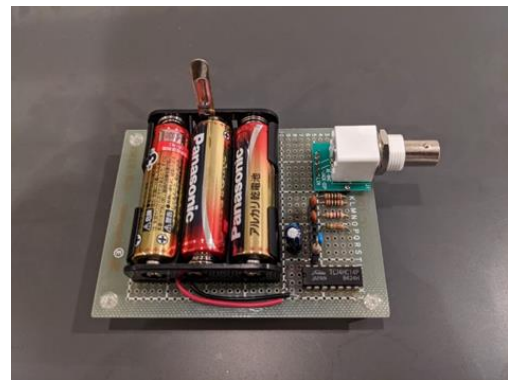
図13 試作した方形波発振回路
