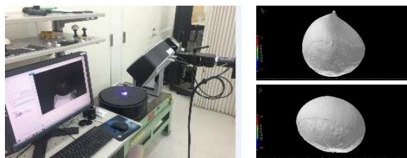
図 5 3D スキャナによる栗のデジタルデータ化
