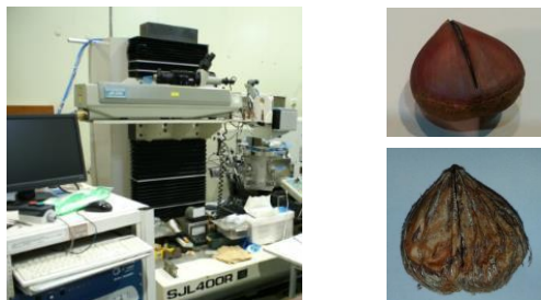
図9 レーザー加工機による鬼皮の傷入
