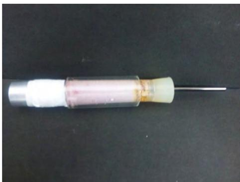
図4 カラム型色素増感太陽電池のモデル
