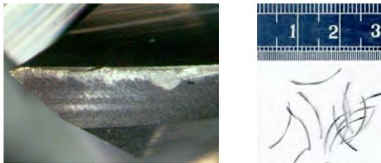
図3 SUS304における工具摩耗状況及び切り屑の状態
