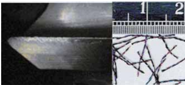
図8 SKD11での工具摩耗状況及び切り屑の状態 (⑧ V200-f0.06-乾式 400Passでの例)
