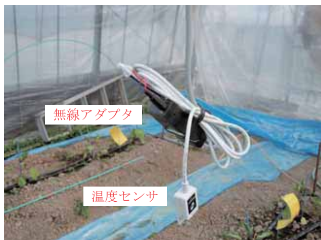
図2 温度計測ノードの外観写真
