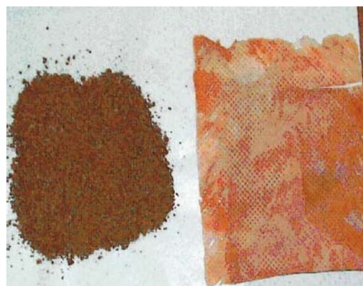
図5. 包剤化脱硫剤の使用後の状態
