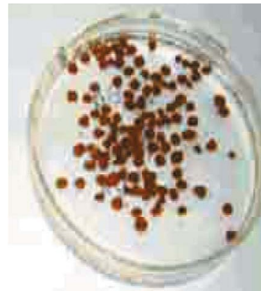
図3. 粒脱硫剤の水中崩壊試験
