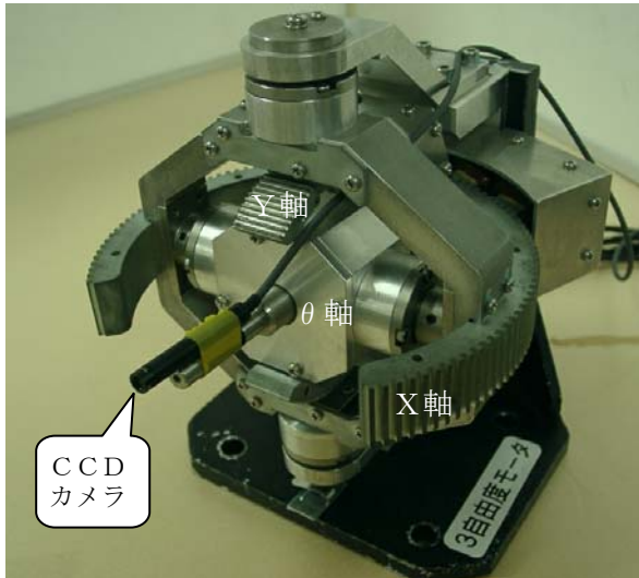
図6 CCDカメラと3自由度モータ
