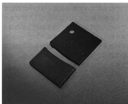
Fig. 1 Broken sample after bending test. 曲げ試験後の破断試料。
